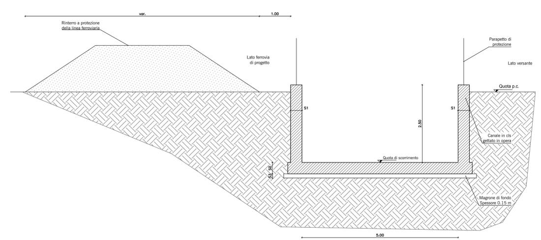
Sezione tipo scatolare in c.a.
