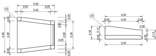
CANALETTA IN CLS 1/2 Ø300 DI DRENAGGIO BANCATE RILEVATO
