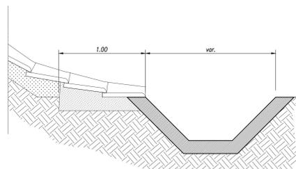
SEZIONE DI POSA TUBAZIONE IN PVC
