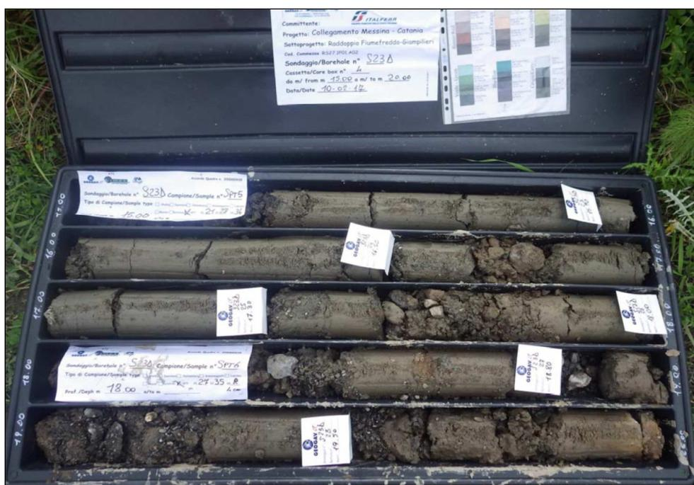
Figura 1 – Dettaglio della matrice sabbioso-ghiaiosa delle b2;ba;bb;g1;(MSS) in cassetta (S23D – 15-20 m dal p.c.)
