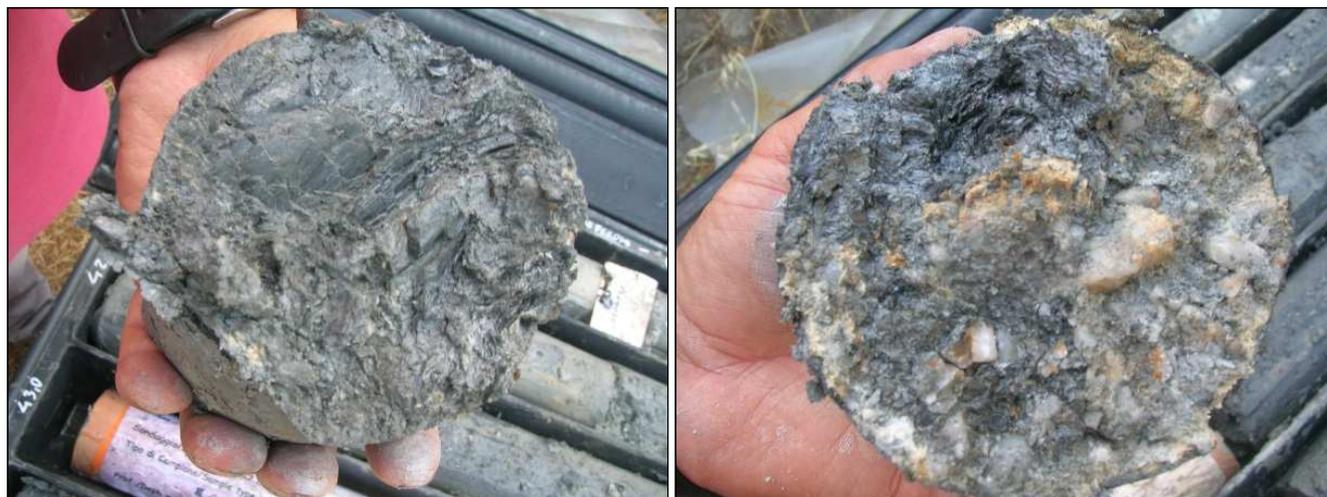
**Figura 21 – Sondaggio S15D, dettaglio della microstruttura scistosa con quarzo**
