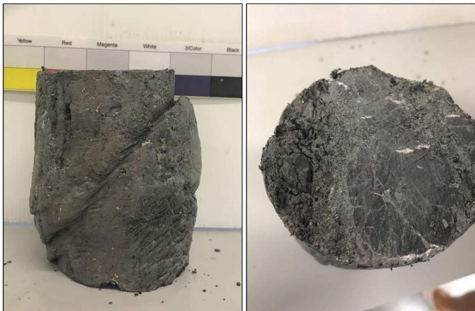
**Figura 29 - Formazione FDN/GLD/TAM/MMF: prova triassale – dettaglio della tessitura scistosa a seguito della rottura del provino S13DCH-LC2**
