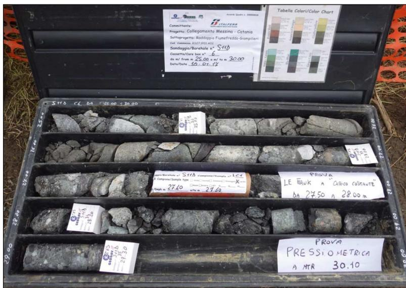
Figura 17 – Sondaggio S11D, cassetta da 25 a 30 m dal p.c.
