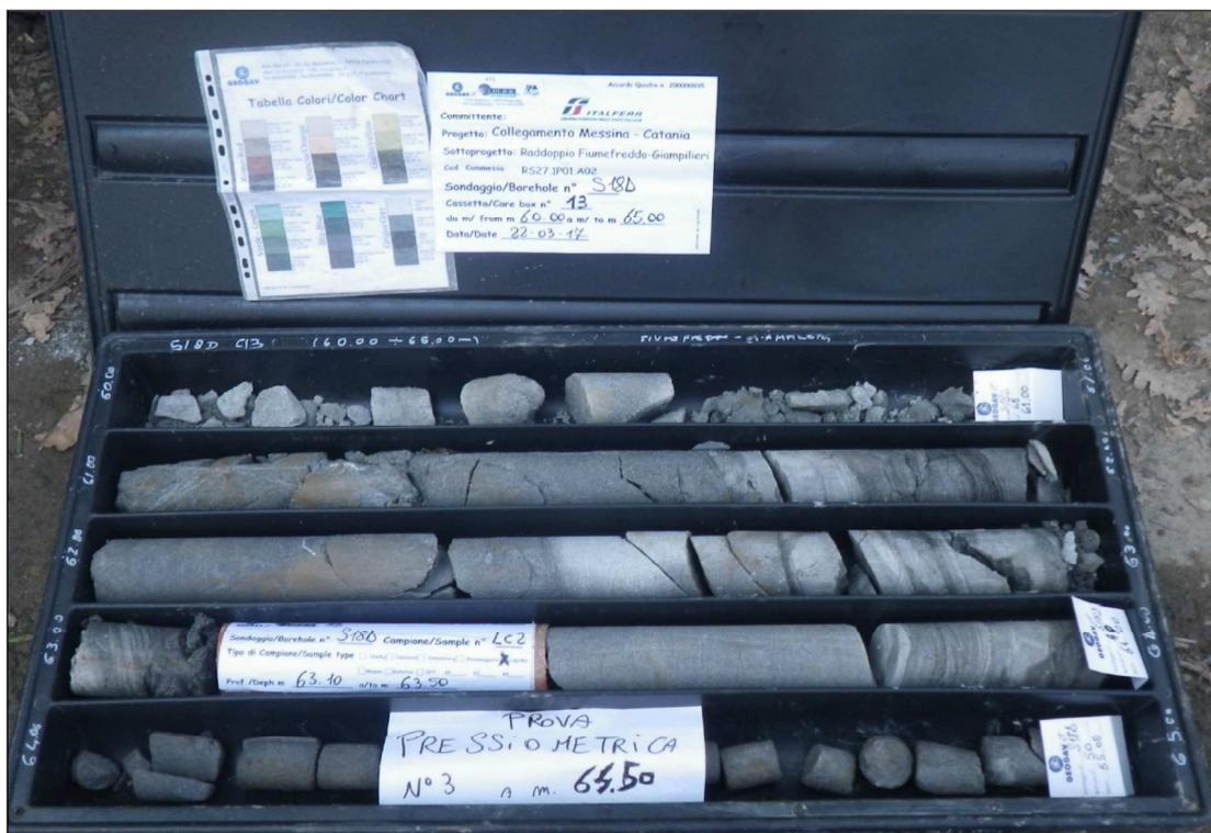
**Figura 12 – Sondaggio S18D, cassetta da 60 a 65 m dal p.c.**
