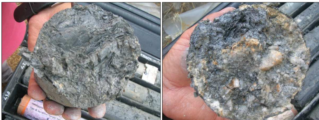
Figura 19 – Sondaggio S15D, dettaglio della microstruttura scistosa con quarzo
