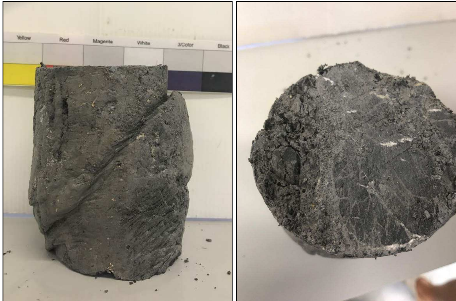
Figura 27 - Formazione FDN/GLD/TAM/MMF: prova triassale – dettaglio della tessitura scistosa a seguito della rottura del provino S13DCH-LC2
