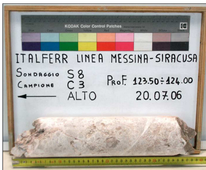
Figura 13 - Campione di dolomia GLOa – S8C3
