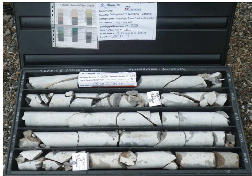
Figura 19 – Sondaggio S27D, cassetta da 25 a 30 m dal p.c.
