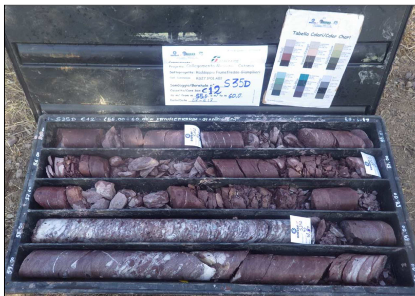
Figura 10 – Sondaggio S35D, cassetta da 55 a 60 m dal p.c.
