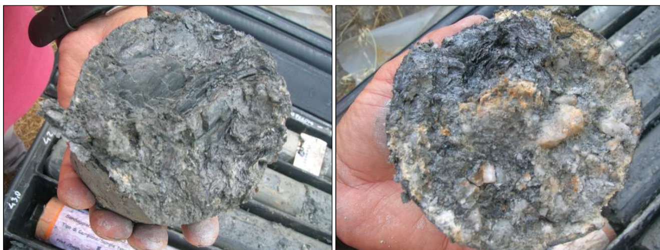
Figura 1 – Sondaggio S15D, dettaglio della microstruttura scistosa con quarzo
