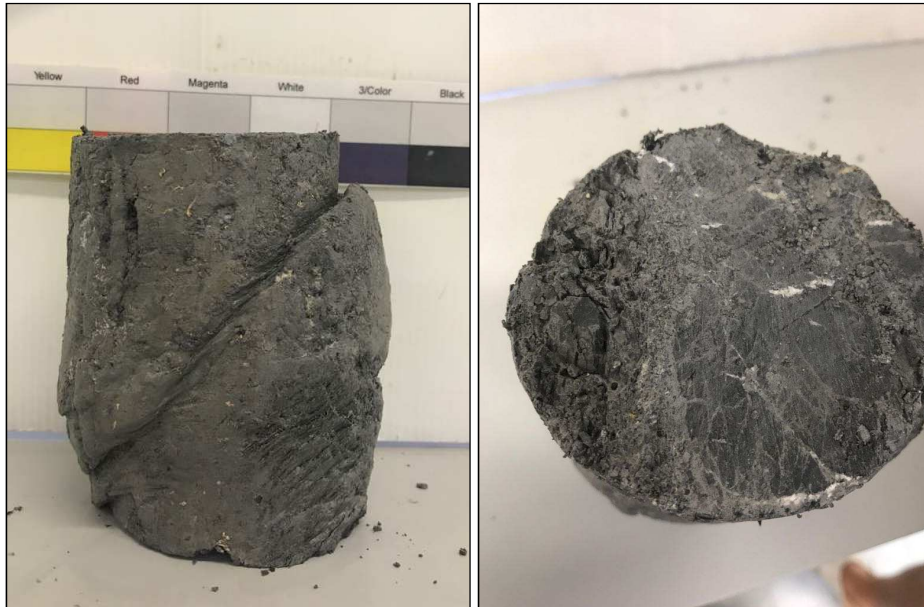
Figura 9 - Formazione FDN/GLD/TAM/MMF: prova triassale – dettaglio della tessitura scistosa a seguito della rottura del provino S13DCH-LC2
