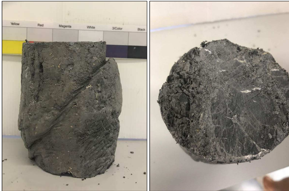
Figura 9 - Formazione FDN/GLD/TAM/MMF: prova triassiale – dettaglio della tessitura scistosa a seguito della rottura del provino S13DCH-LC2
