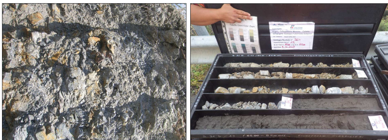
Figura 10 – A sinistra, affioramento di PMAa massivo (area rilievo G148), a destra risultanze del sondaggio S36D (cassetta alla profondità di 105-110 m dal p.c.).
