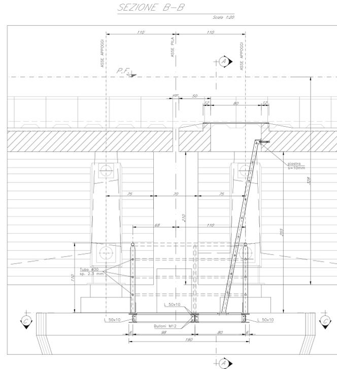
Scaletta di accesso ai pulvini per impalcato a struttura mista acc.-cls
