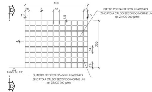
**POZZETTO E GRIGLIA PARAFOLGIE PER PLUVIALE**
