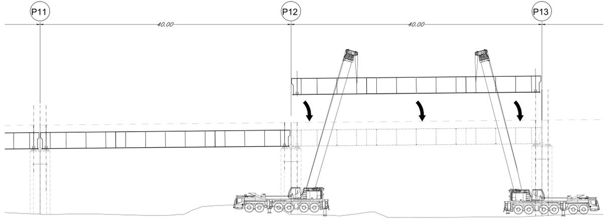
PIANTE FASI DI MONTAGGIO
