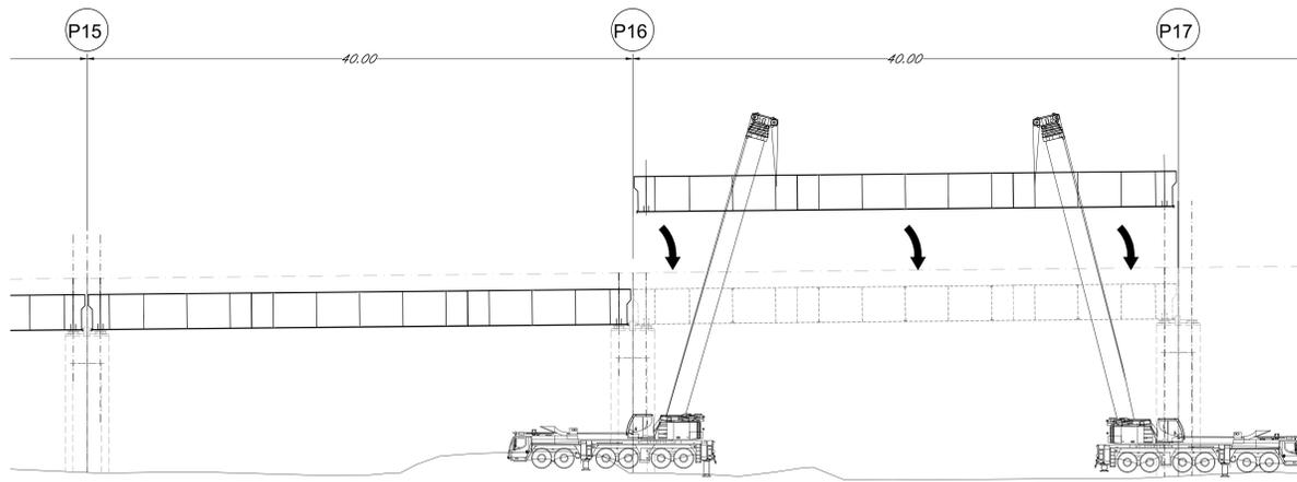
PIANTE FASI DI MONTAGGIO
