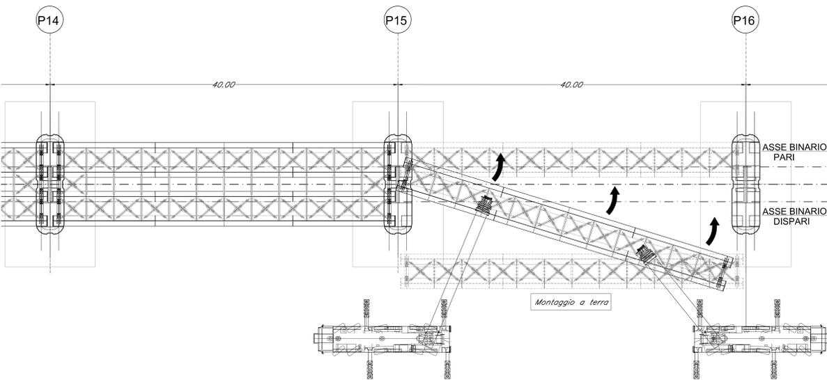
PIANTE FASI DI MONTAGGIO
