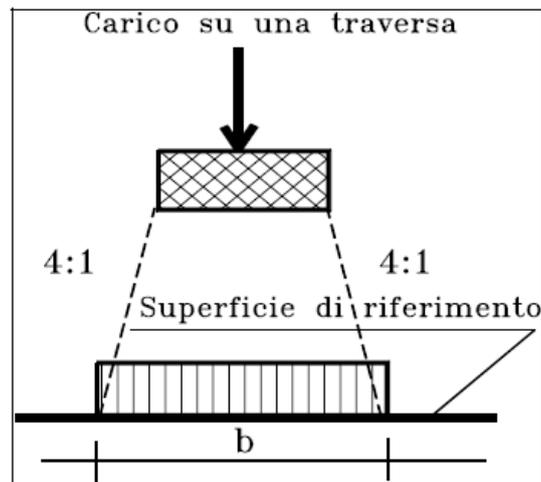
**Figura 10 – meccanismo di ripartizione longitudinale per mezzo di traversa e ballast**
