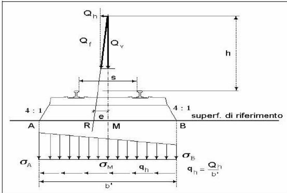
Figura 11 – meccanismo di ripartizione longitudinale per mezzo di traversa e ballast – ponte in rettilineo
