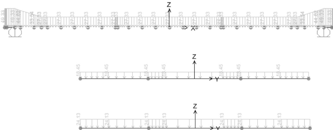
I carichi derivanti dalla soletta (G1s) sono stati schematizzati secondo carichi e momenti uniformemente distribuiti lungo i frame delle travi, secondo le aree di influenza di ogni trave.
