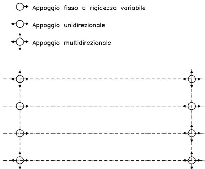
**Figura 4 –Schema appoggi**
