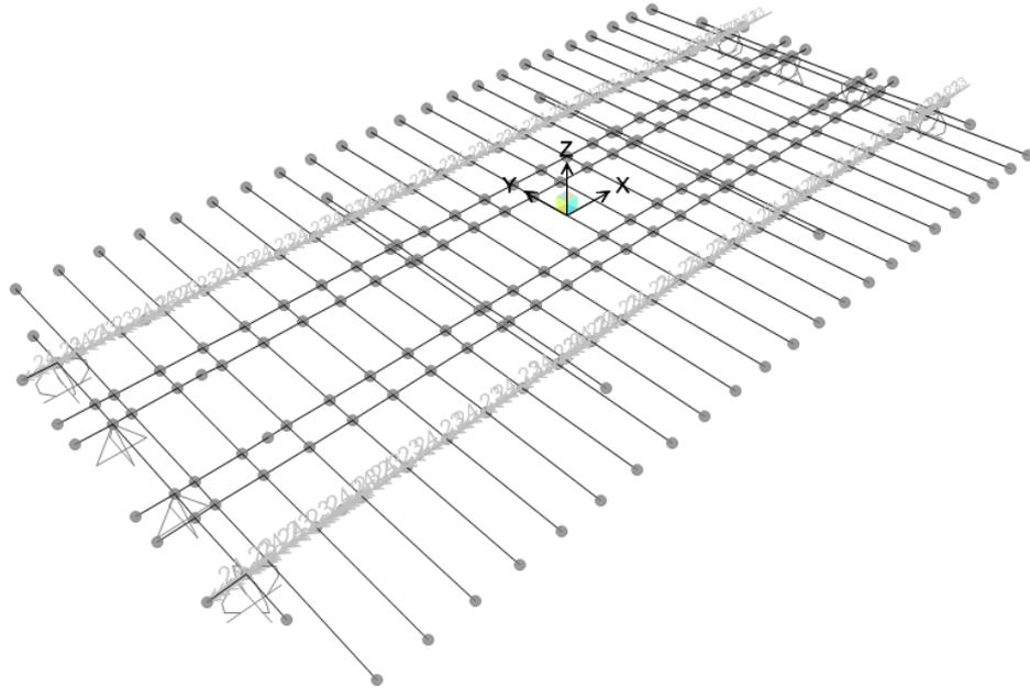
Di seguito si riportano le caratteristiche inerziali degli elementi. Come da prassi, agli elementi frame della soletta è stata dimezzata la rigidità torsionale.
