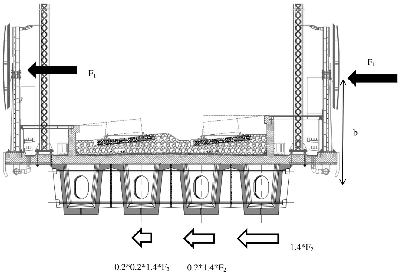
Figura 20 – schema di applicazione dell'azione del vento
