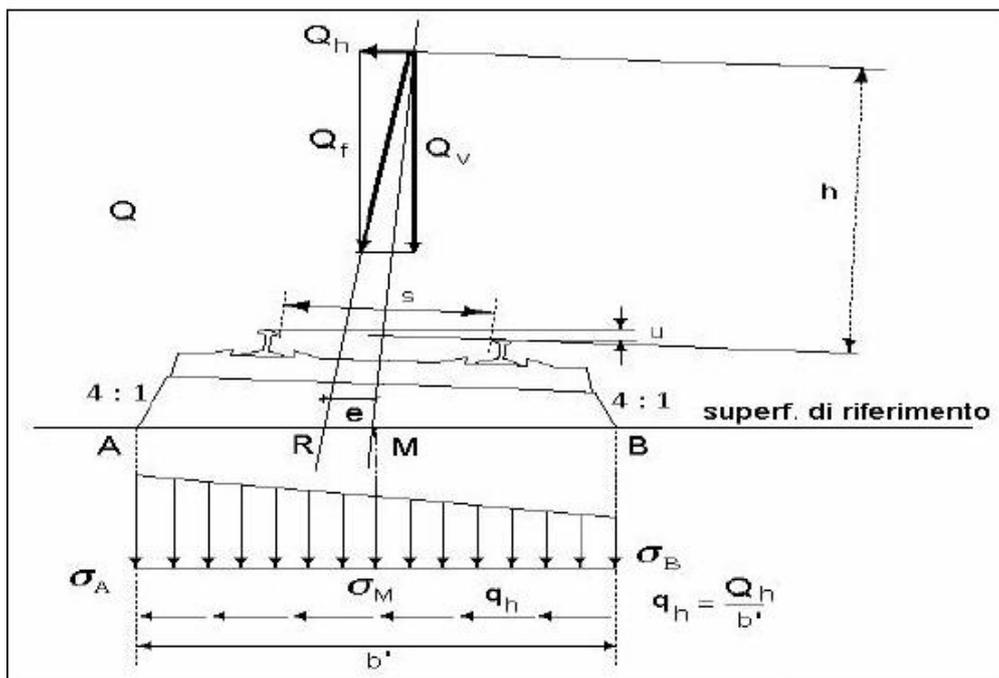
Figura 12 – meccanismo di ripartizione longitudinale per mezzo di traversa e ballast – ponte in curva
