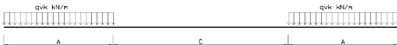
Figura 9 – Treno di carico SW
