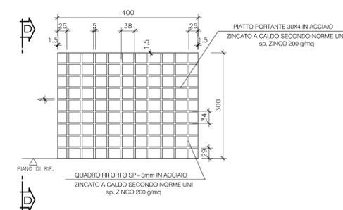
**POZZETTO E GRIGLIA PARAFOLGIE PER PLUVIALE**
