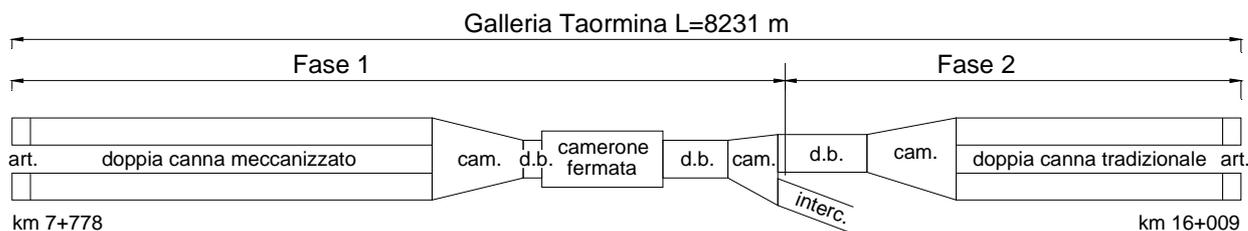
In relazione alla configurazione di tale sistema di gallerie, e in presenza della stazione interrata di TAORMINA, nel rispetto delle normative vigenti in materia di sicurezza (cfr STI/SRT 2008), sono previste tre uscite di sicurezza per l'esodo dei passeggeri e l'accesso delle squadre di soccorso; due nell'ambito della stazione di TAORMINA ed una in finestra sull'interconnessione di Letojanni (Km 0+313 IC).
