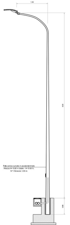
Palo conico curvato in acciaio laminato
