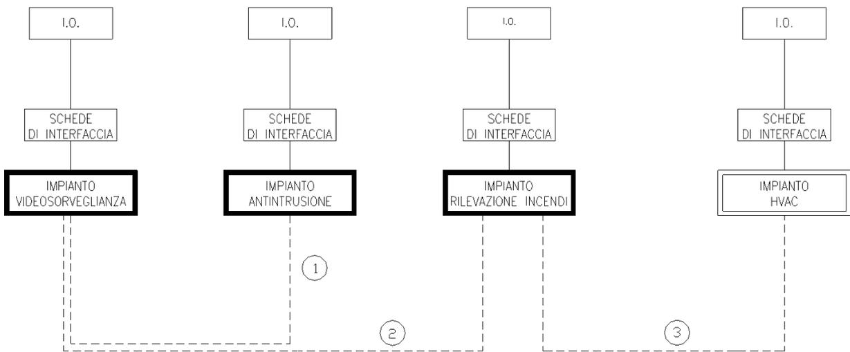
Per il collegamento con il sistema di supervisione la centrale TVCC dovrà essere dotata di apposita interfaccia e linguaggio di comunicazione basato su protocolli di comunicazione non proprietari.
