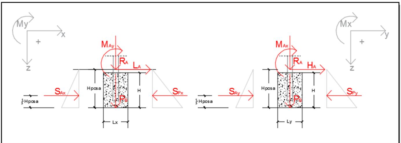
Di seguito si riportano le verifiche al ribaltamento del blocco di fondazione nella sola direzione x, essendo la struttura simmetrica in tutte le direzioni.
