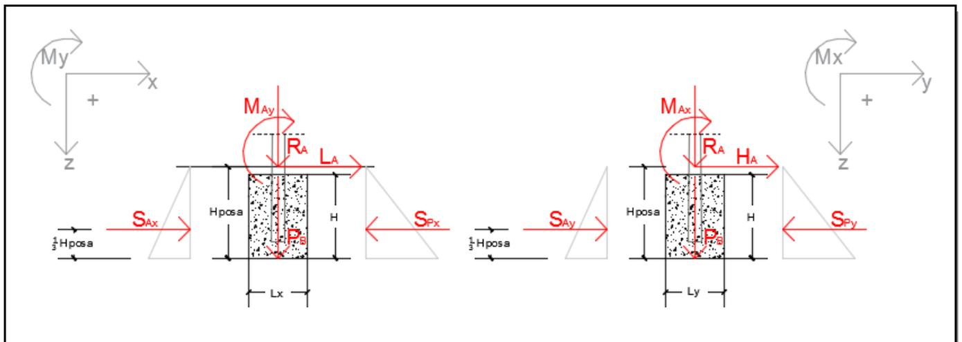
Le verifiche al ribaltamento del blocco di fondazione nella sola direzione più sfavorevole risultano essere tutte verificate in condizioni EQU (più gravosa) che in SLV, come si evince dagli equilibri globali e dalle verifiche di resistenza (pressione max) sul suolo, ampiamente verificate.
