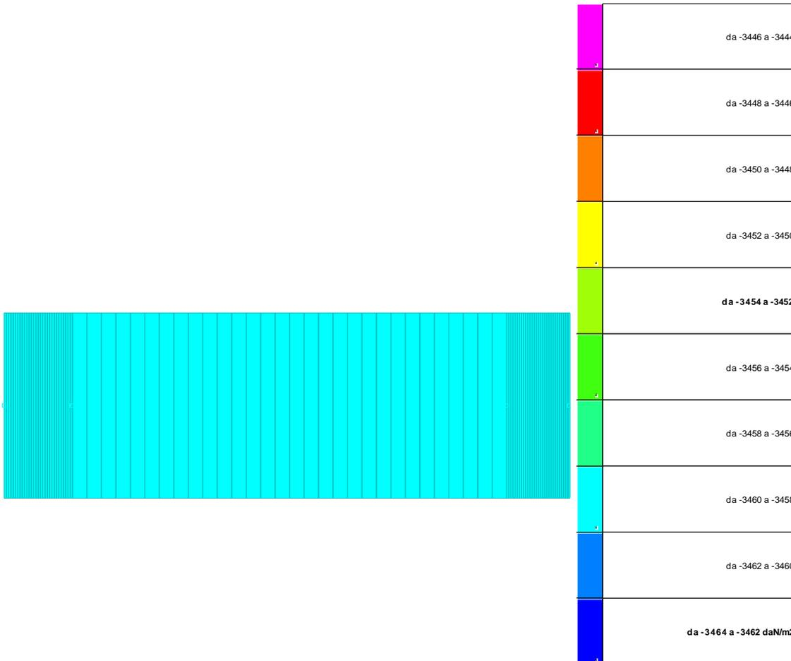
Immagine: rappresentazione in pianta delle massime compressioni sul terreno in famiglie SLE/SLD.
