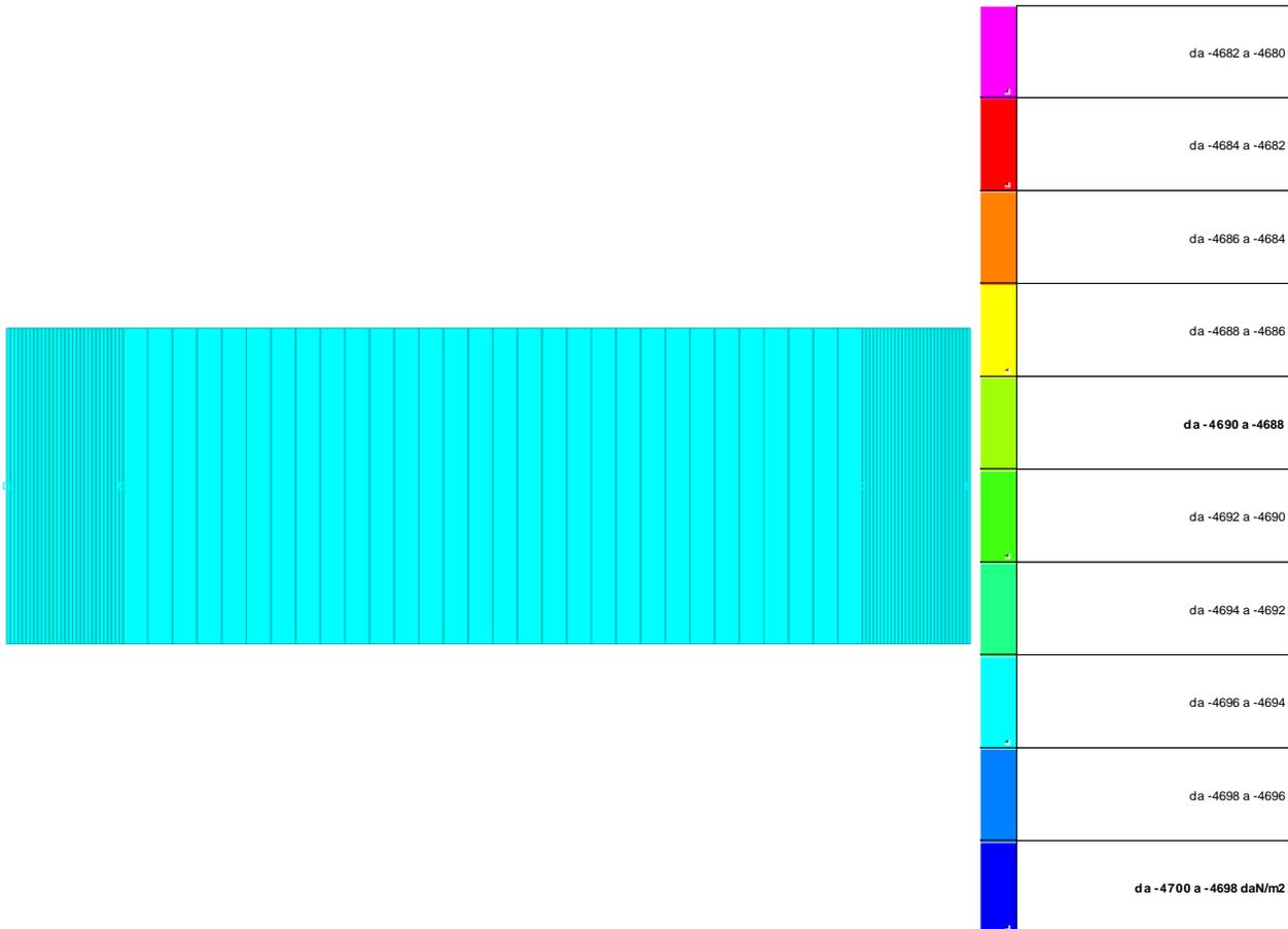
Immagine: rappresentazione in pianta delle massime compressioni sul terreno in famiglia SLU.
