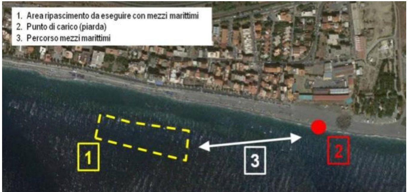
Figura 2 7: Ripascimento eseguito con mezzi marittimi
