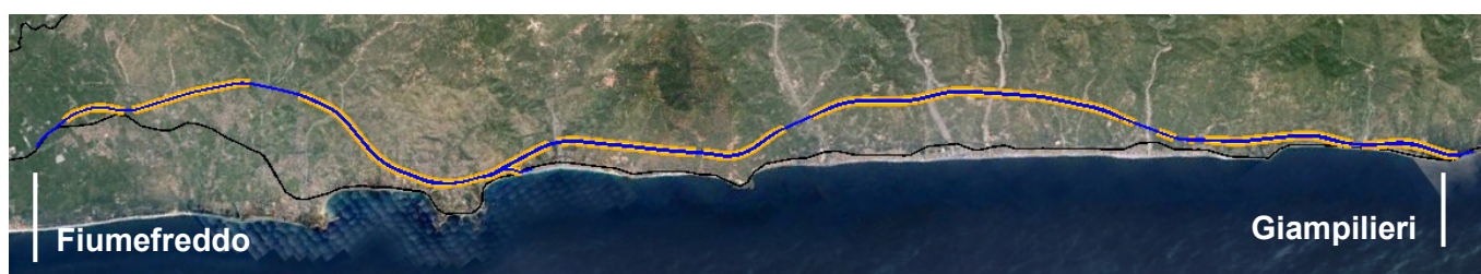
Figura 2-2 Foto da satellite (fonte Google Earth) dell'area di intervento con tracciato di progetto (in blu, con gallerie evidenziate in arancione) e la linea esistente (in nero)
