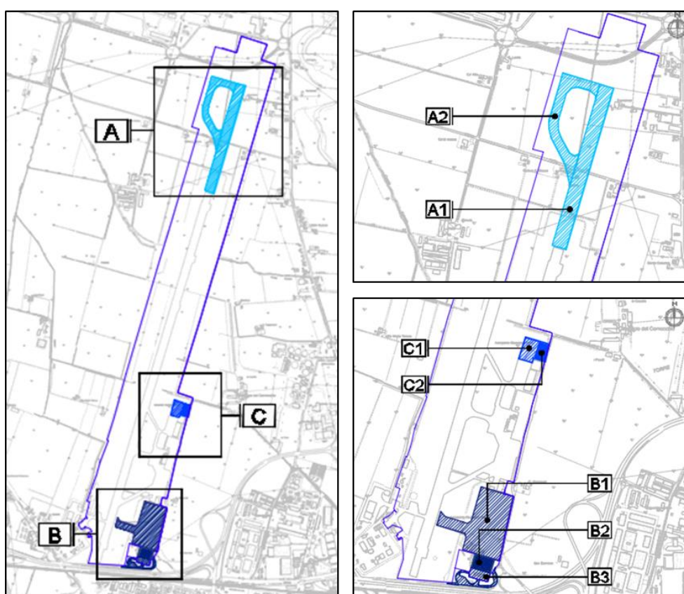
Figura 2-2 Aeroporto di Parma, Piano di Sviluppo Aeroportuale: schematizzazione delle opere e degli interventi
