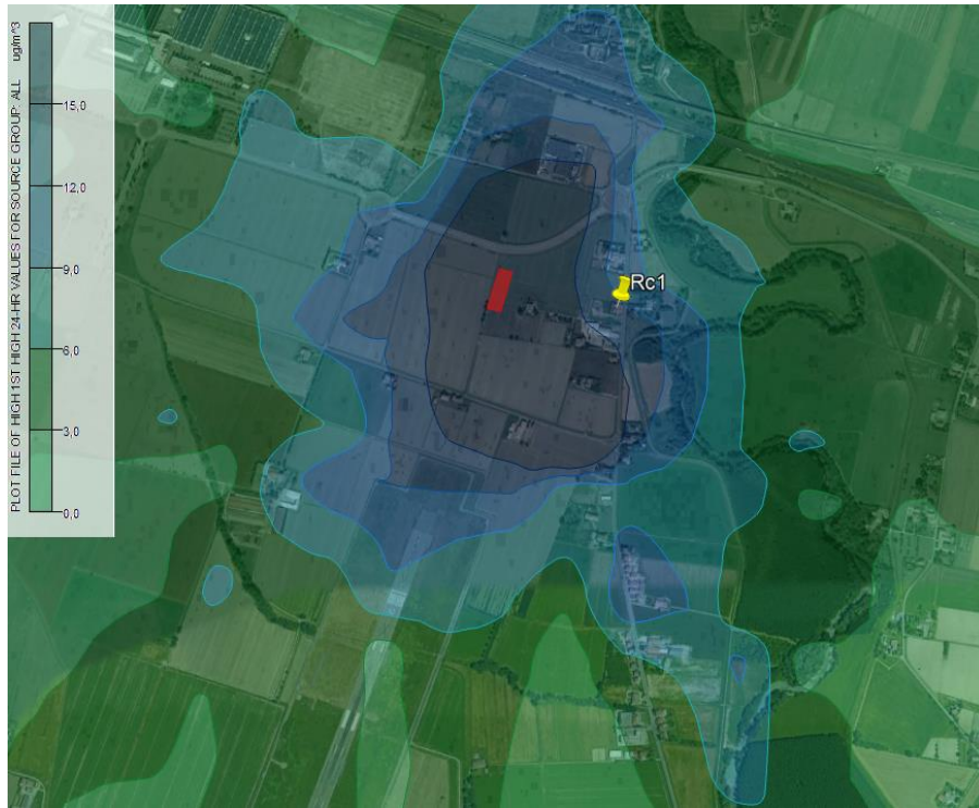
Figura 3-5 Concentrazioni di PM10 1st valori media giornaliera cantiere C1
