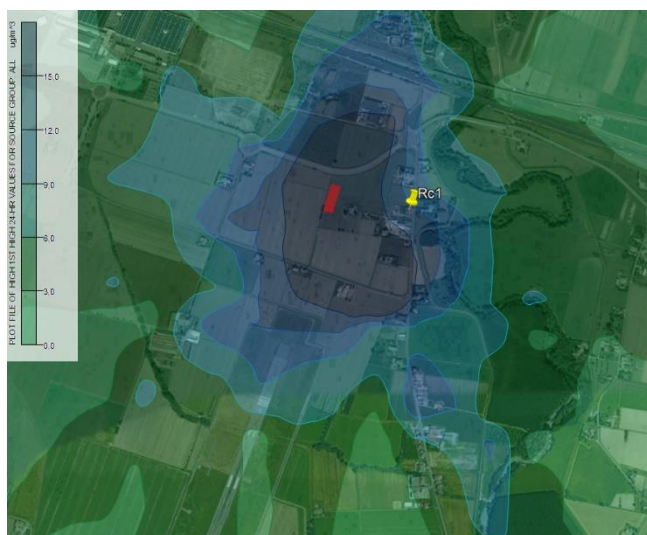
Figura 7-3 Concentrazioni di PM 10 1st valori media giornaliera cantiere C1
