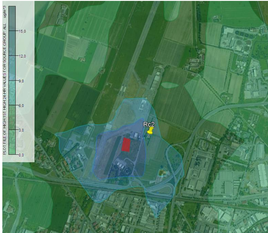
Figura 3-6 Concentrazioni di PM10 1st valori media giornaliera cantiere C2
