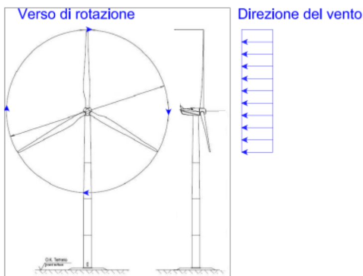
Relazione tra direzione del vento e rotazione delle pale.
