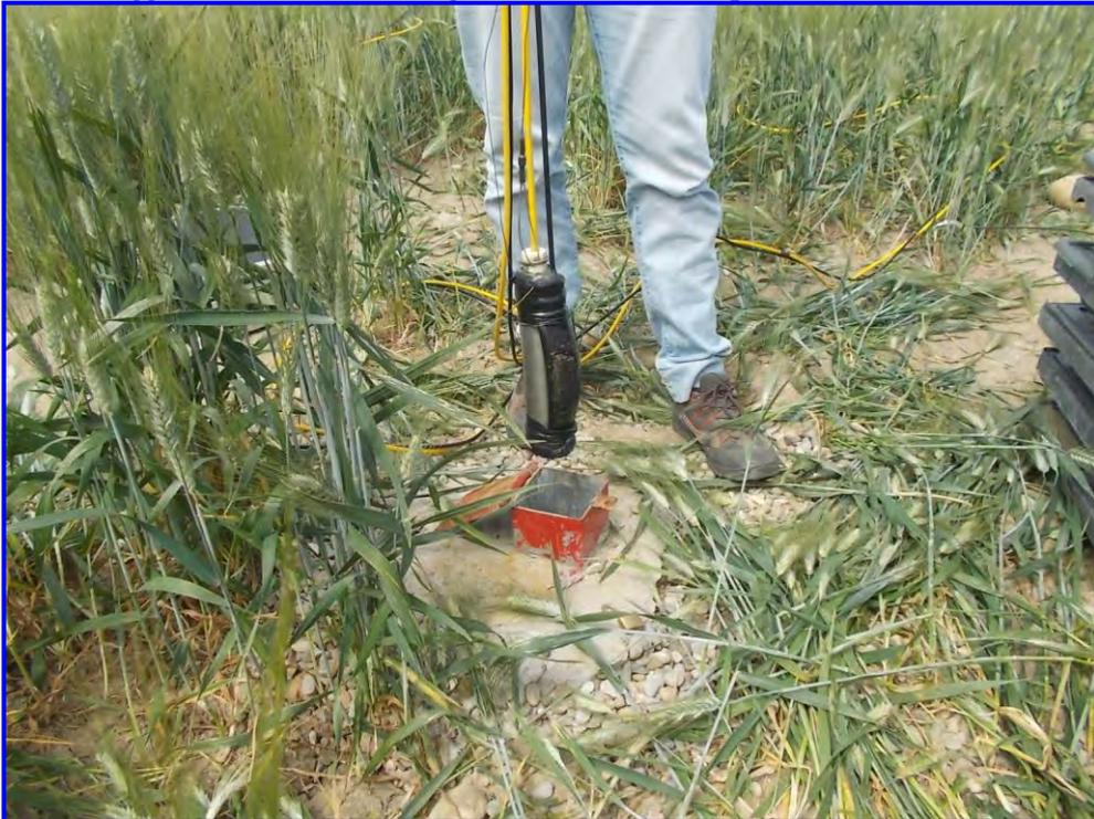
**Fig. 9 – Sonda geofonica da foro a tre componenti (3 geofoni ortogonali Geospace a 4.5Hz).**
