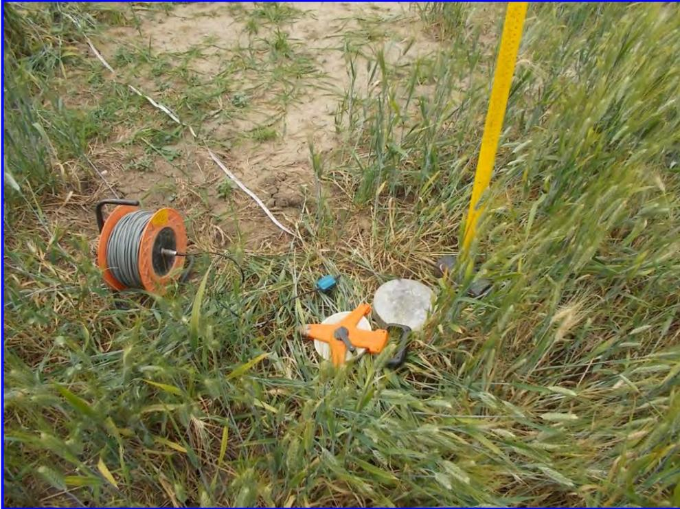
**Fig. 10 – Sorgente energizzata, costituita da massa battente su piastra di alluminio. Come starter/trigger è stato utilizzato un geofono verticale Geospace a 14Hz.**
