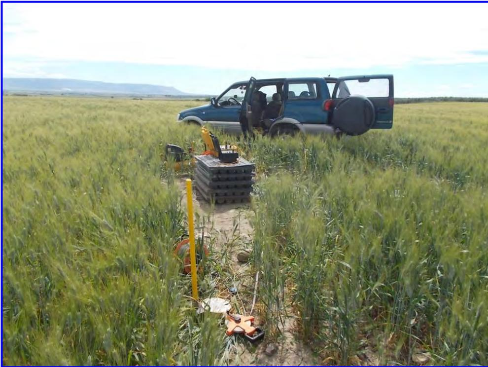
**Fig. 8 – Sorgente energizzata, costituita da massa battente su piastra di alluminio. Come starter/trigger è stato utilizzato un geofono verticale Geospace a 14Hz.**
