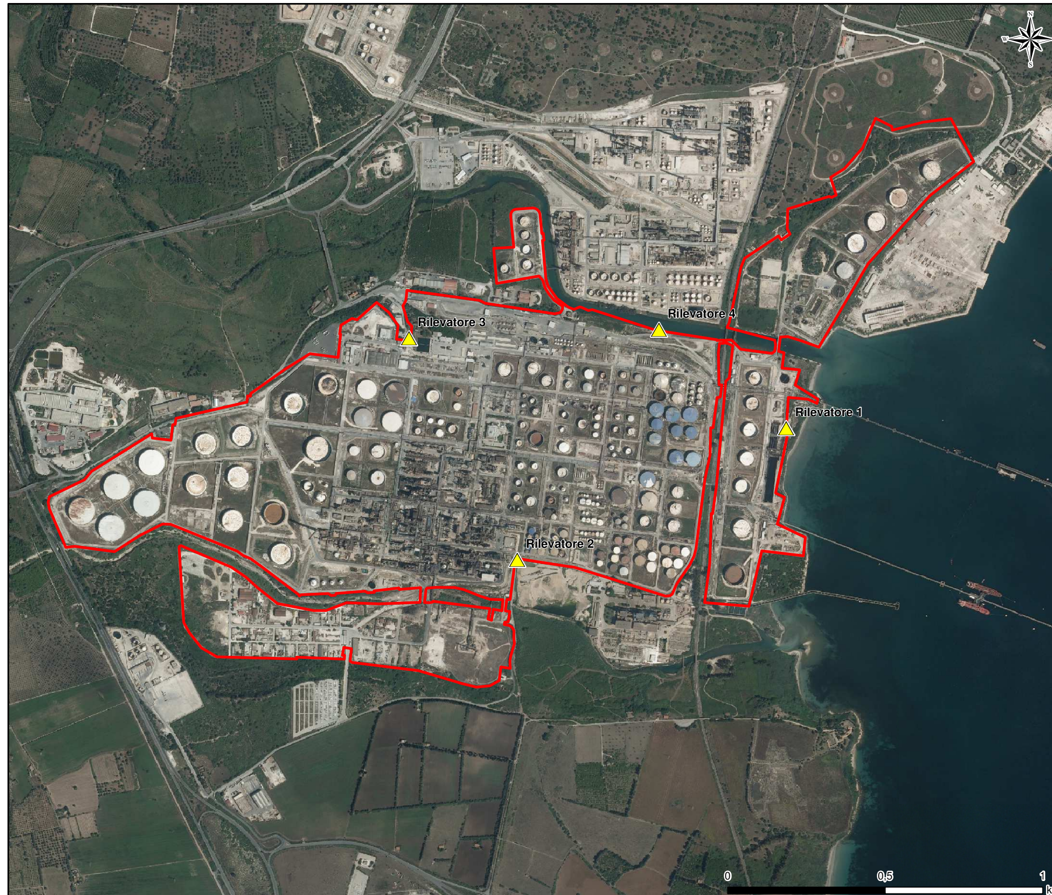
Figura 5b Individuazione punti al perimetro in cui installare i rilevatori di COV
