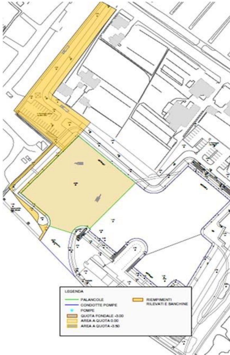
Fig. 2 – Rimozione del terreno di riporto del settore 1 e riutilizzo dello stesso per la realizzazione di rilevati e banchine
