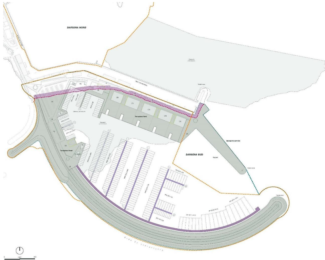
Figura 3. Planimetria degli interventi di demolizione e ricostruzione
