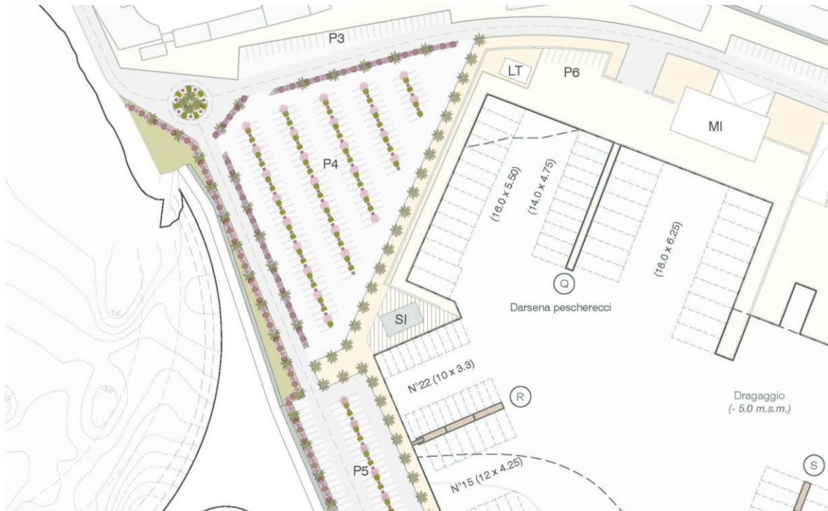
Figura 15. Sistemazione palme banchina Terrapieno Ovest
