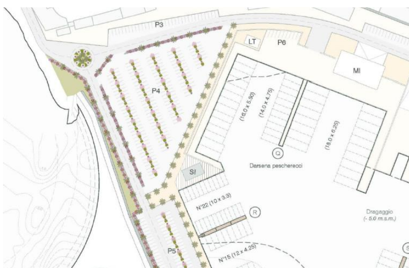
Figura 8. Sistemazione a verde delle aree parcheggio e delle aree perimetrali - planimetria
