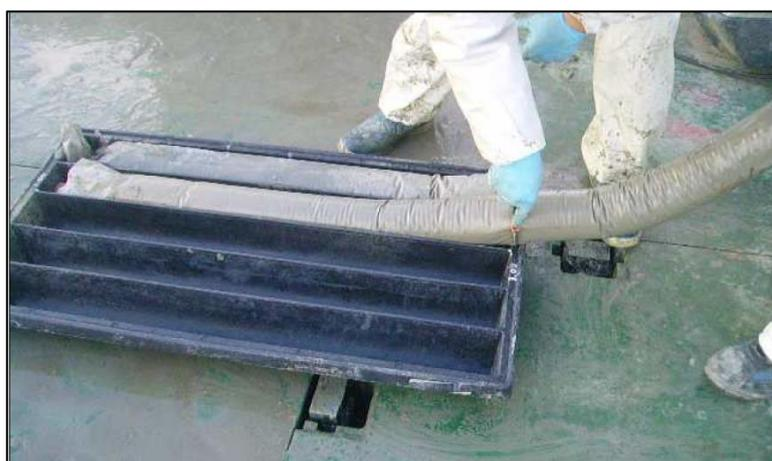
**Figura 22.** Operazione di estrusione delle carote dal carotiere
