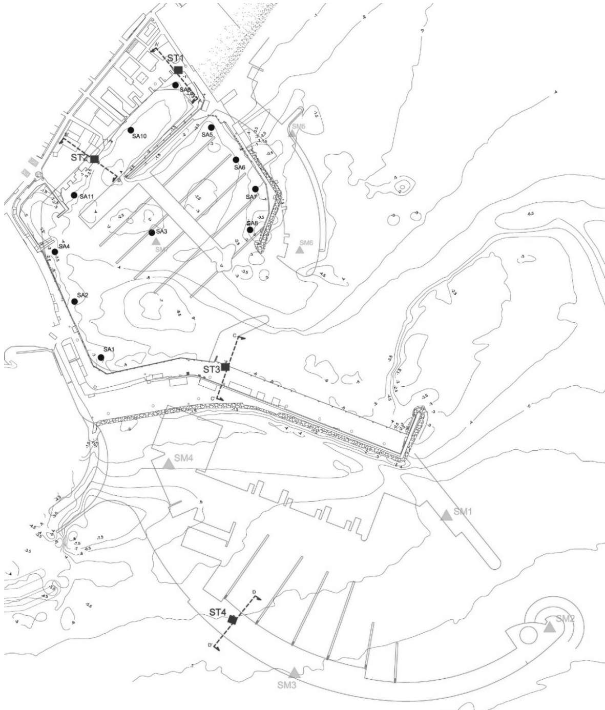
Figura 6: Planimetria con linee batimetriche e ubicazione dei sondaggi geognostici
