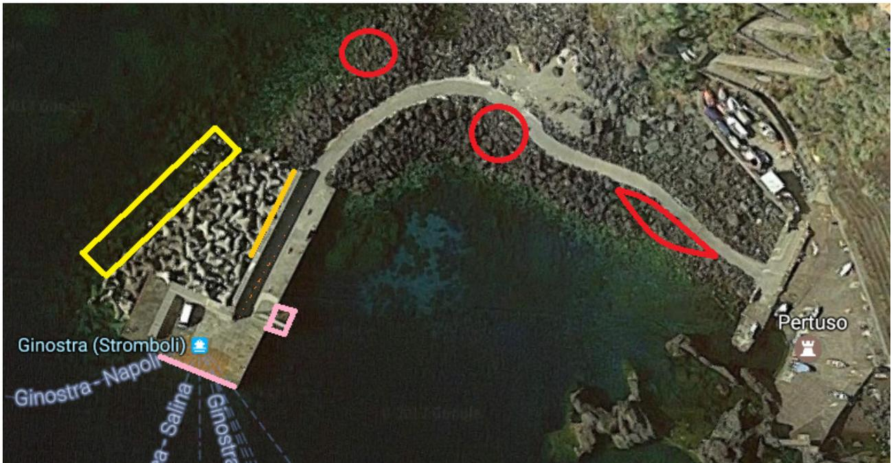
Durante il sopralluogo è emersa la necessità, segnalata dagli ormeggiatori, di provvedere con urgenza alla manutenzione della struttura del respingente aliscafi ed alla collocazione di un parasigolo del cassone di testata nel tratto di ormeggio delle navi.
