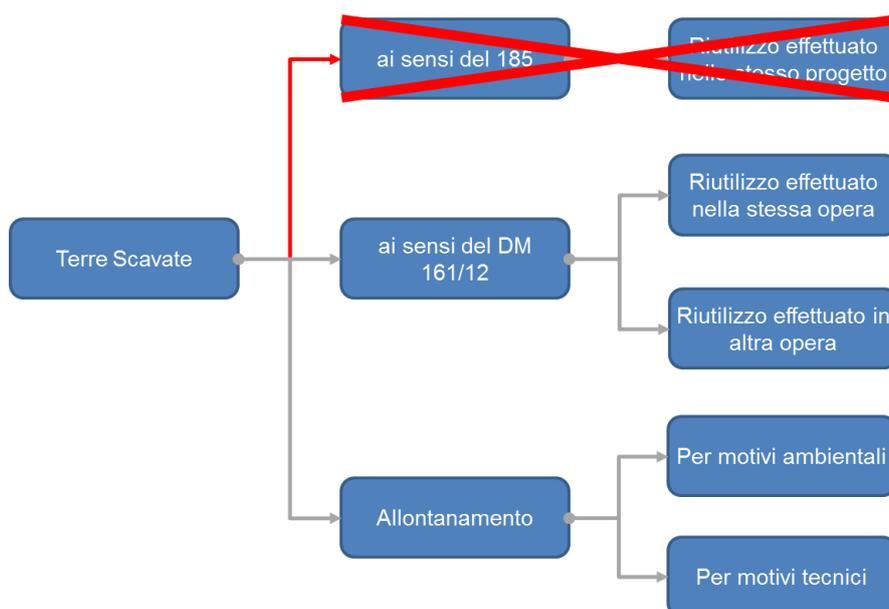
**Figura 3-2 Criteri seguiti nella gestione delle terre e rocce scavate**
