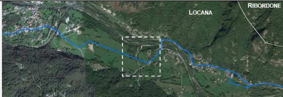
La proposta di variante dell'immagine seguente è volta a ridurre l'impatto sulla vegetazione. Il tracciato fuori strada si mantiene in area agricola fino a raggiungere la strada esistente. Rimane l'attraversamento in subalveo del corso d'acqua in un punto in cui la vegetazione spondale è più ridotta.
