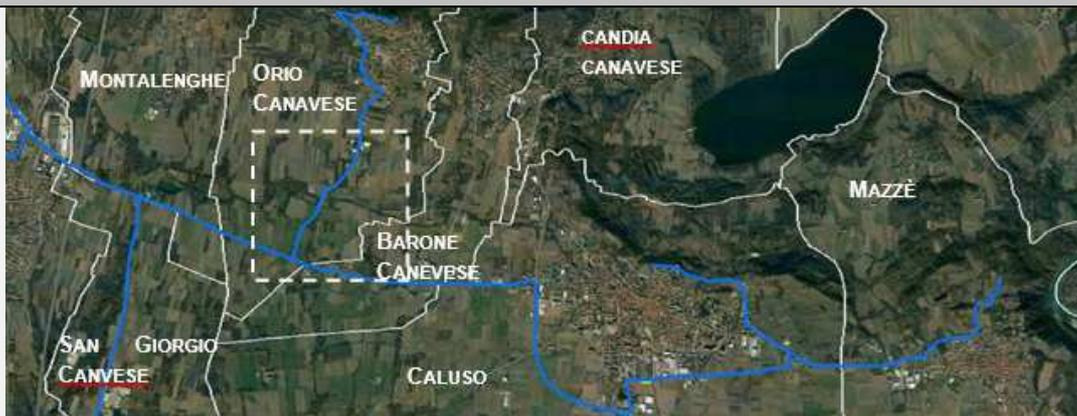
Il tracciato B6-BB6 si sviluppa in un territorio prevalentemente agricolo dalla SP53 a Orio Canavese. Circa a metà del tratto, si trova l'attraversamento del Canale demaniale di Caluso. Il tracciato originale prevedeva l'attraversamento in subalveo con discostamento dalla strada per un tratto di circa 300 m.
