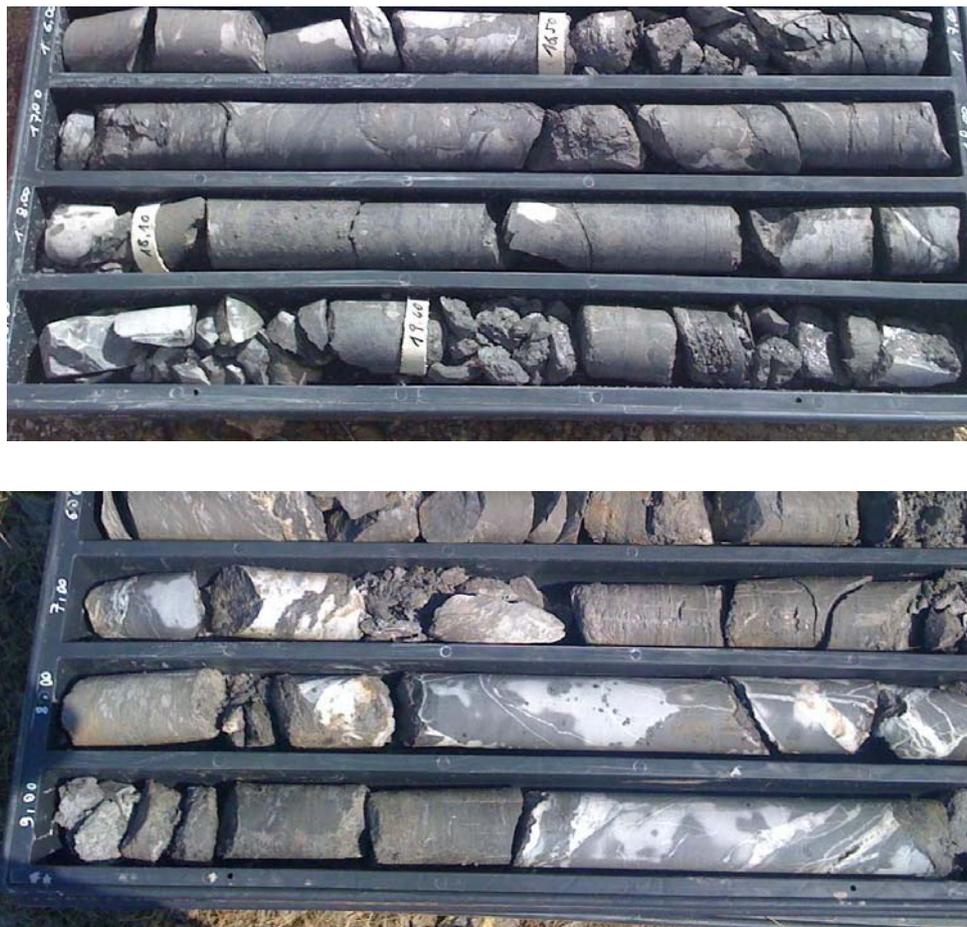
Fig 27 - Facies tipica in sondaggio del Flysch di Poggio Pallone (Sondaggi 3/2-SD13 3/2-SD14)
