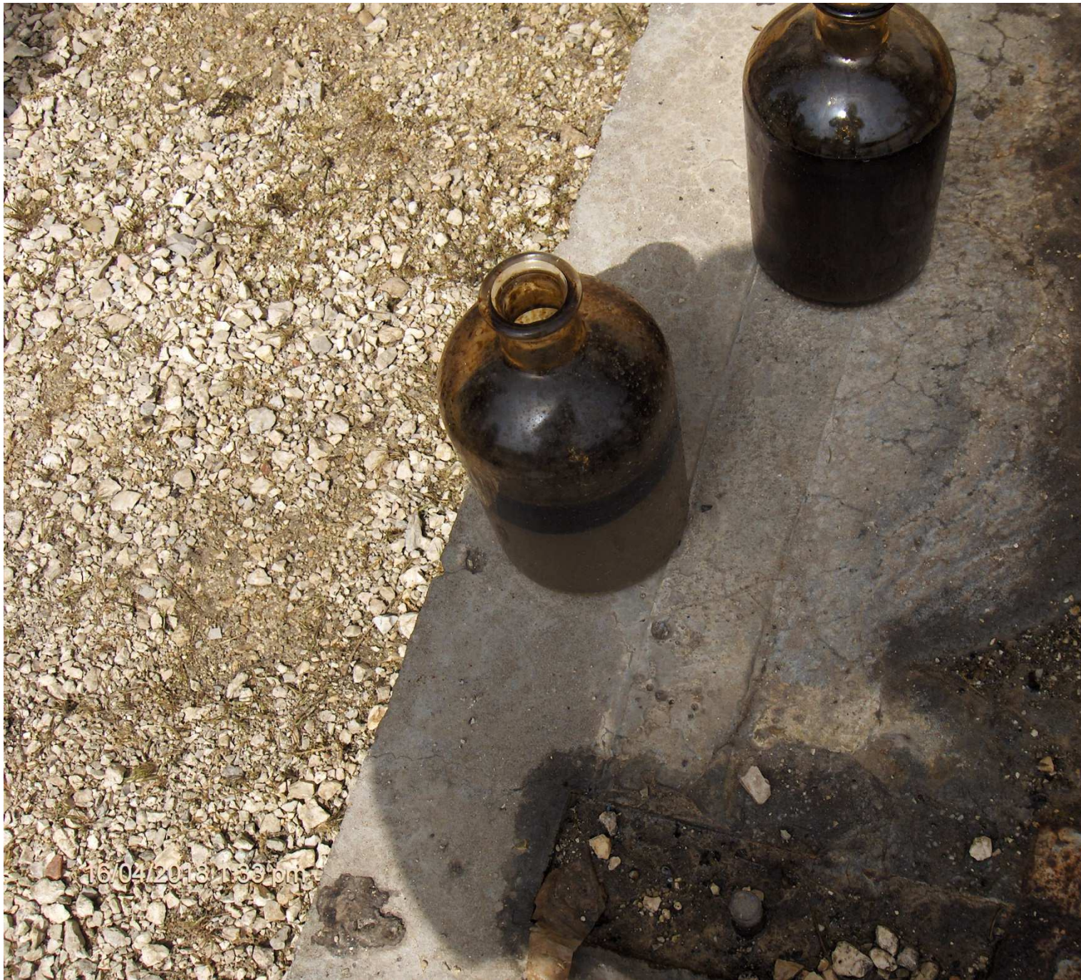
Figura 9 bottiglie con campione di liquido aspirato dalla pompa dal tetto del tk 61
