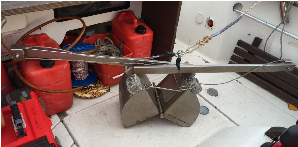
Figura 4 – Porto di Catania: Imbarcazione Neptune1 ed equipaggiamento impiegati per il campionamento di sedimenti nel lato esterno del molo di Levante. Nell’immagine in basso dettaglio della benna Van-Veen impiegata.
