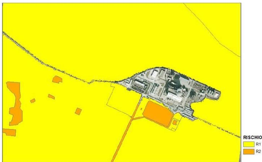
Figura 3.5 - Perimetrazione del Rischio idraulico per l'area di interesse (documento Sogin NPVA01037)
