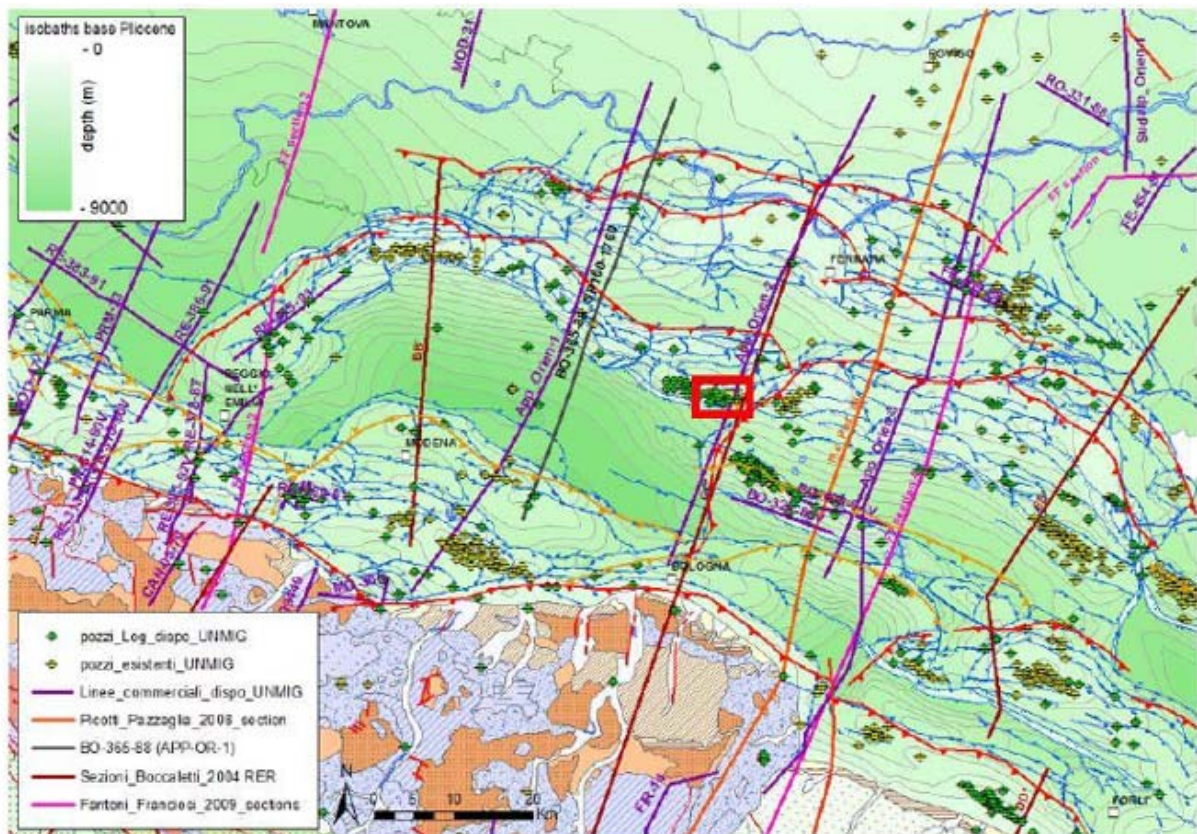
Fig. 7: Impostazione strutturale nell'intorno della zona di interesse (rettangolo rosso). Sono riportate le isobate della base delle unità plioceniche sotto tutta la Pianura Padana (Consiglio Nazionale delle Ricerche 1992), i principali lineamenti tettonici sono estratti da Fantoni e Franciosi (2010), le sezioni geologiche di interesse da Fantoni e Franciosi (2009)
