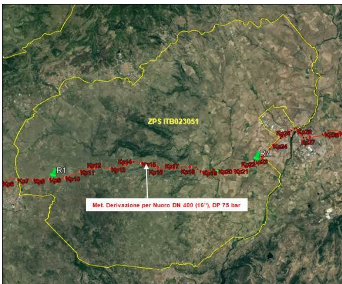
Fig. 5.4.A). In corrispondenza di ognuno di essi è stato identificato il corrispettivo punto-sorgente sonora (distanza perpendicolare tra recettore e sorgente); questi punti saranno utilizzati poi per la stima previsionale degli impatti acustici determinati dalle attività di cantiere.
