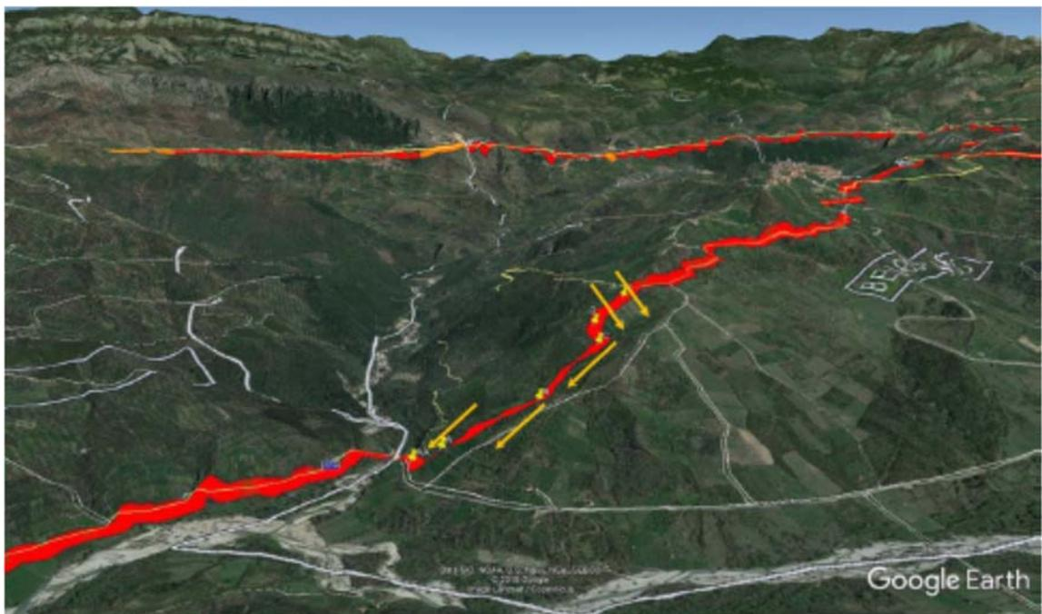
La particolare conformazione del terreno dovrebbe far valutare con attenzione le posizioni delle sezioni di controllo in quanto sono presenti curve brusche (si vedano i punti A e AA) lungo il tracciato e cambi di pendenza del terreno in cui il gasdotto è posato (punti B e C
