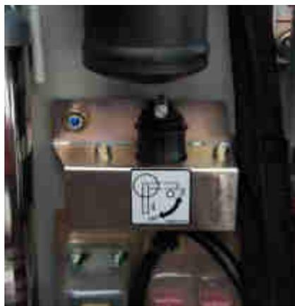
Staccabatteria nel vano motore.
