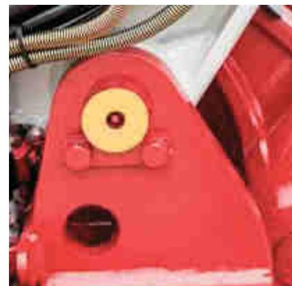
Punti di ingrassaggio ben visibili colorati in giallo. Sistema meccanico di blocco del braccio quando tutto a sinistra. Sistema di recupero del gioco dei perni del brandeggio.
