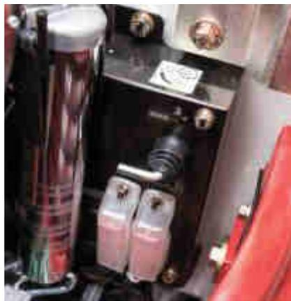
Staccabatteria nel vano motore.
