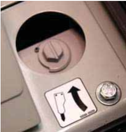
Rubinetto selettore impianto ausiliario doppio effetto (pinza) o singolo effetto (martello).
