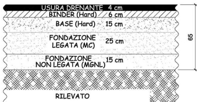
Figura 1: Sovrastruttura di progetto
