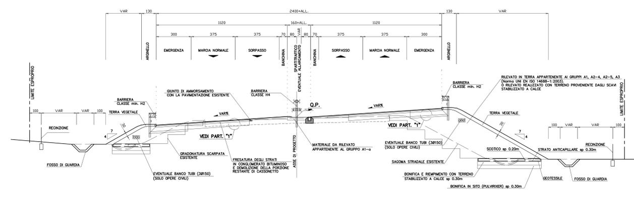
SEZIONE TIPO IN RETTIFILLO (AMPLIAMENTO ASIMMETRICO S.S. n°1 VARIANTE AURELIA) – scala 1:100
