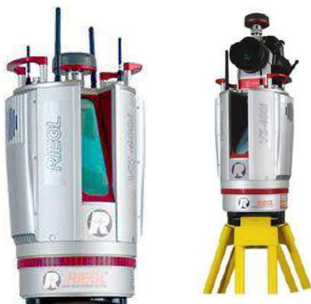
Figura 9 - Laser scanner utilizzato nel rilievo - RIEGL VZ-400i.
