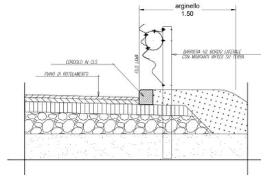
SEZIONE TIPO IN TRINCEA CON BARRIERA H2BL
