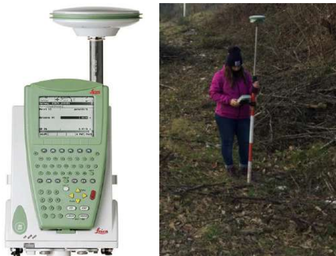
Figura 6 - Ricevitore GNSS Leica 1200 e rilievo GPS.
