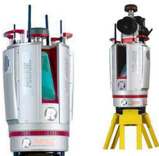
Figura 14 - Laser scanner utilizzato nel rilievo - RIEGL VZ-400i.
