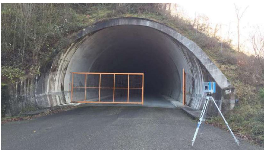
Figura 18 –Laser scanner RIEGL VZ-400i durante il rilievo della galleria S.Antonio.
