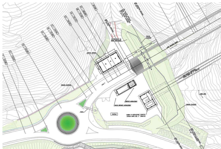
Figura 3 – Sistemazione imbocco lato Umbria
