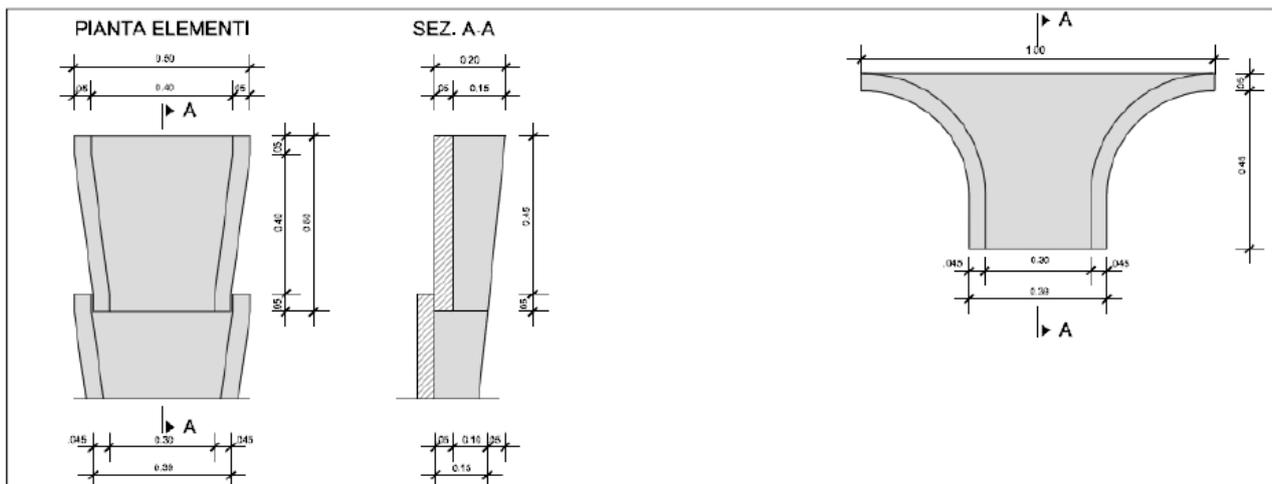
Figura 2 Dettaglio in sezione e pianta degli embrici
